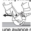
lors des travaux de tronçonnage, travaillez toujours en sens opposé (voir photo). Sinon, la machine risque de sortir de la ligne de coupe de façon incontrôlée. Toujours travailler avec une avance mesurée, adaptée au matériau à
